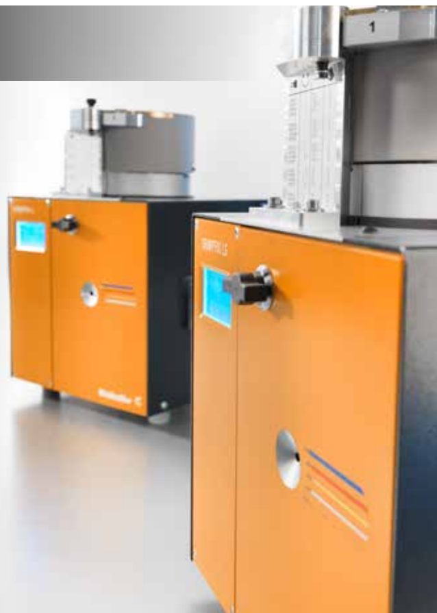
トリガーセンサを調整することで、適切なストリップ長を調整可能。
