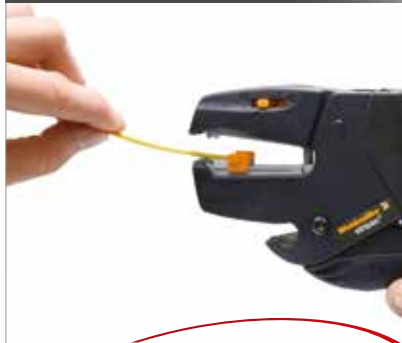
電線被覆剥き
